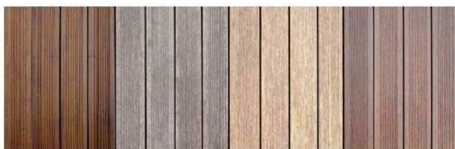
Après l'installation 2 ans après l'utilisation Après le nettoyage Après la maintenance
