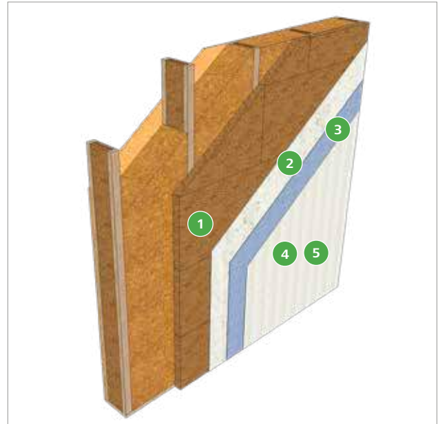
Ossature bois avec contreventement intérieur
