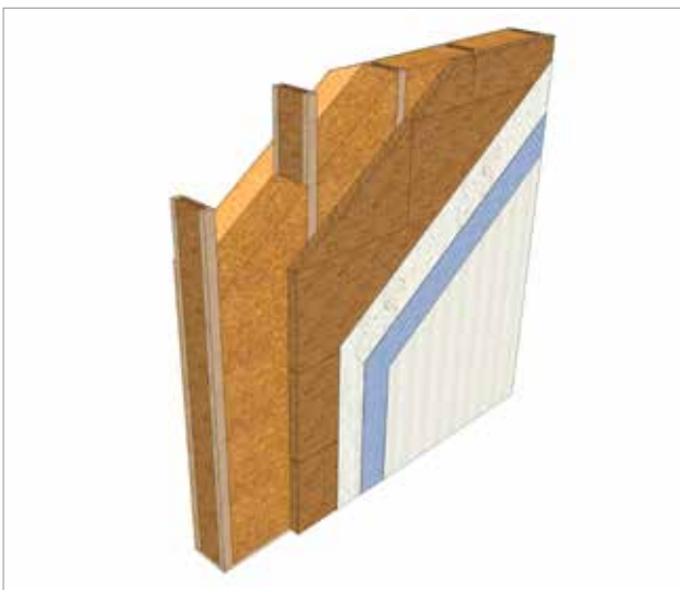
Ossature bois sans contreventement extérieur
